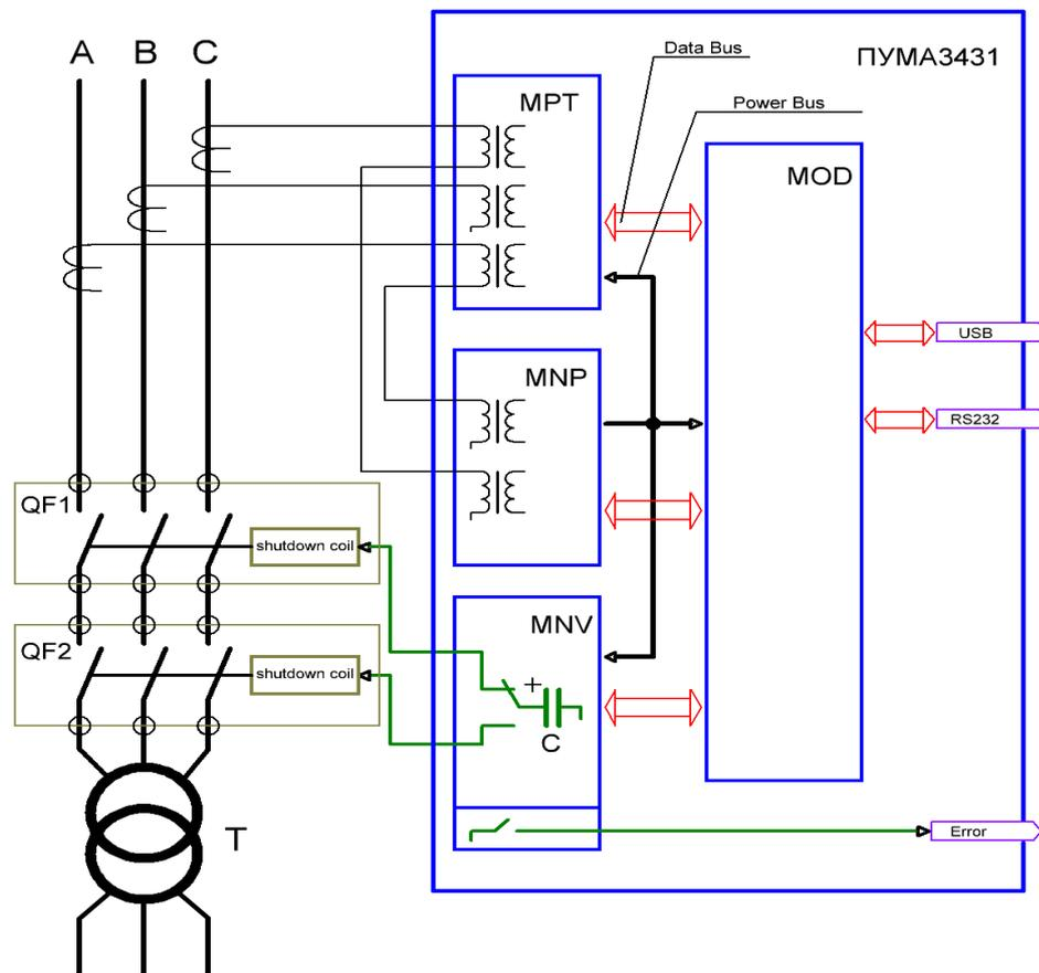
МПТ(МРТ) – модуль преобразования тока, обеспечивает сопряжение контролируемых токовых цепей с портами контроллера МОД(MOD);
